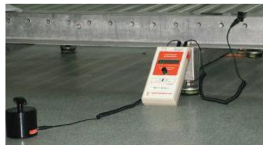
Ilustración 3. Verificación del calzado conforme a la Norma UNE-CLC/TR 60079-32-1 con un comprobador de calzado antielectrostático y verificación del pavimento conforme a la Norma UNE-EN-61340-4-1 con un Megohmetro electrostático
