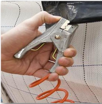
Ilustración 7. Detalle de la lengüeta conductiva electrostática de puesta a tierra electrostática del big bag Tipo C.
