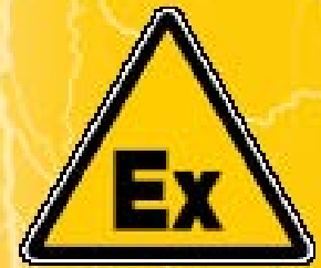
Zona con riesgo de atmósferas explosivas
